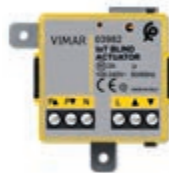
03982 Komandni aparat za 1 roletu s usmjeravanjem lamela s izlazom za preklopni relej za motor cosφ 0,6 2 A 100-240 V~ 50/60 Hz, daljinskim upravljačem, bežičnom tehnologijom Bluetooth® 5.0 za mrežni sustav View Wireless i Zigbee 3.0
