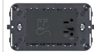
09290.CM 230 V~ 50/60 Hz, s izolacijskim transformatorom 20 VA, 230 V~ i 120 V~ izlaznim naponom - 3 modula. Dubina: 42 mm
