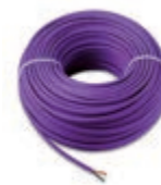
732I.C.100 Kabel Due Fili Plus za postavljanje iznutra/izvana, upleteni vodiči 2x1 mm 2 , izolator i obloga LSZH, klasa Cca - s1b, d1, a1, radna temperatura -25/+70 °C, stupanj izolacije 600/1000 V, prilagođen podzemnom postavljanju u suhom cjevovodu ili onom s mogućnošću drenaže (maks. 24 sata mokrom), nije prikladan za izravnu podzemnu ugradnju, adekvatna za instalaciju u kablu de Categoria I (U0 = 400 V), ljubičasti - zavojnica od 100 m
