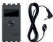
20584.1 Sučelje za za prijenos upravljačkih sklopova By-me prijammiku IR, opremljen kabelom 3 m. Dubina: 41 mm
