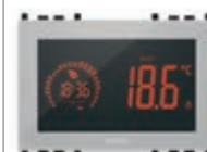
02955.BN Termostat sa zaslonom osjetljivim na dodir za upravljanje funkcijama ON/OFF i PID temperature, 1 ulaz senzora temperature, 1 višefunkcijski ulaz, 1 ulaz RJ9 za mjerač energije (02960) preklopni relejni izlaz 5(2) A 230 V~ - 3 modula. Dubina: 35,3 mm
