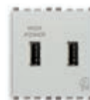
20295.N 5 V 2,1 A napajač s izlazom, 2 izlaza USB koji sveukupno daju 2,1 A, 120-230 V~ 50/60 Hz - 2 modula. Dubina: 37 mm
