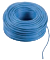
732H.E.100 Kabel Due Fili Plus za postavljanje iznutra, upleteni vodiči 2x1 mm 2 , obloga od PVC-a, klasa CPR Eca, radna temperatura -25/+70 °C, nije prikladan za prolaz na podzemnoj kanalicu, adekvatna za instalaciju u kablu de Categoria I (U0 = 400 V), plava - zavojnica od 100 m
