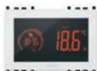
02955.B Termostat sa zaslonom osjetljivim na dodir za upravljanje funkcijama ON/OFF i PID temperature, 1 ulaz senzora temperature, 1 višefunkcijski ulaz, 1 ulaz RJ9 za mjerač energije (02960) preklopni relejni izlaz 5(2) A 230 V~ - 3 modula. Dubina: 35,3 mm
