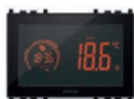
02955 Termostat sa zaslonom osjetljivim na dodir za upravljanje funkcijama ON/OFF i PID temperature, 1 ulaz senzora temperature, 1 višefunkcijski ulaz, 1 ulaz RJ9 za mjerač energije (02960) preklopni relejni izlaz 5(2) A 230 V~ - 3 modula. Dubina: 35,3 mm
