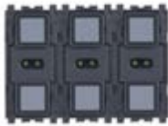
▲ 21126 6 nezavisnih gumba, 8 nepolariziranih ulaza, 7 izlaza u čvrstom stanju za nepolarizirane kontakte, napajanje 9-32 Vdc - 3 modula. Dubina: 22,8 mm
