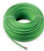
732I.E.100 Kabel Due Fili Plus za postavljanje iznutra/izvana, upleteni vodiči 2x1 mm 2 , izolator i obloga LSZH, klasa CPR Eca, radna temperatura -25/+70 °C, stupanj izolacije 600/1000 V, prilagođen podzemnom postavljanju u suhom cjevovodu ili onom s mogućnošću drenaže (maks. 24 sata mokrom), nije prikladan za izravnu podzemnu ugradnju, adekvatna za instalaciju u kablu de Categoria I (U0 = 400 V), zelena - zavojnica od 100 m
