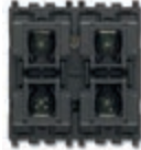
01582 4 gumba + aktivator 1 rolete s usmjeravanjem lamela , relejni izlaz za motor cosφ 0,6 2 A 120-240 V~ 50/60 Hz - 2 modula Dubina: 37 mm
