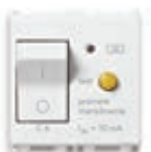
14411.06 C 6, I_{\Delta n} 10 mA prekidna moć 1500 A - 2 modula. Dubina: 38 mm
