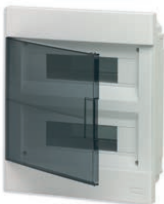
V52424 24 modula, zajedno s vodilicom DIN (60715 TH35), bijela RAL 9003, s prozirnim zatamnjеним vratašcima. Izgubljena snaga: 58 W
