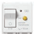
14411.10 C 10, I_{\Delta n} 10 mA prekidna moć 3000 A - 2 modula. Dubina: 38 mm
