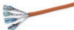
03086.E Kabel kat. 6A S/FTP, oklopljeni, 4 upletene parice, 23 AWG, s omotačem LSZH, klasa CPR Eca, adekvatna za instalaciju sa kabelima de Categorija I (U0 = 400 V), narančasta - 500 m
