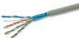
03061.E Kabel kat. 5e F/UTP, oklopljeni, 4 upletene parice, 24 AWG, s omotačem LSZH, klasa CPR Eca, adekvatna za instalaciju sa kabelima de Categorija I (U0 = 400 V), sivi - 305 m
