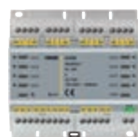
01470 Modul s prethodno programiranih 9 ulaza i 8 izlaza, NO 16 A 120-230 V~ 50/60 Hz s funkcijom upravljanja svjetlima, rolete s usmjeravanjem lamela, gumbi za lokalno upravljanje, 6 modula x 17,5 mm
