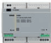
01901 Stereo pojačalo 2 izlaza za difuzore zvuka 8 Ω 10 + 10 W, napajanje 110-230 V~ 50/60 Hz, uklopljeni terminator linije, 6 modula x 17,5 mm
