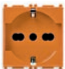
14210.AB.A Utičnica SICURY 2P+T 16 A 250 V~, univerzalna, naran- časta - 2 modula. Dubina: 25 mm
